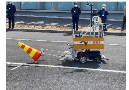
写真2：ロボットによる自動規制材立上げ
